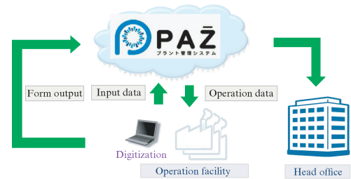
図4 PAZのシステム概要 Fig. 4 System summary of PAZ
